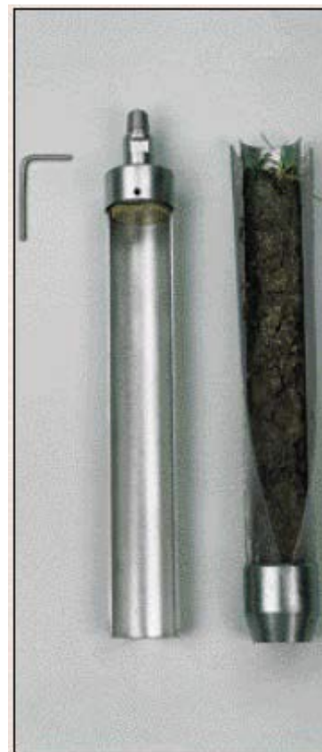
Uzorkivač sa razdeljenom cevi u kojoj je plastična futrola sa uzorkom
