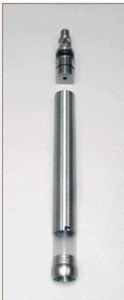
Aparat za jezgrovanje, cev, futrola od plastike, sekuća glava
