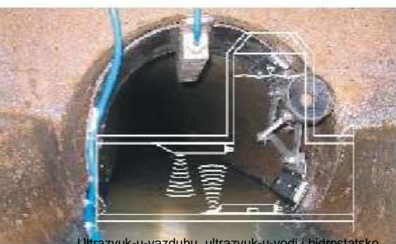
Ultrazvuk-u-vazduhu, ultrazvuk-u-vodi i hidrostatsko merenje - ispitivanje efikasnosti kanala hydrostatic measurement - investigation of channel efficiency
